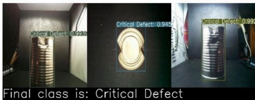
Figura 3 - Defeito crítico detetado pelo algoritmo de [19]
