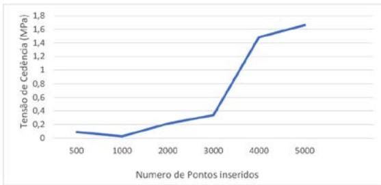
Figura 6 – Variação da tensão de cedência em função do número de pontos.
