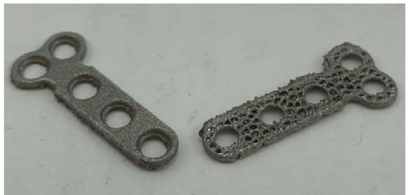
Figura 9 – Placa ortopédica densa e porosa impressa em aço 316L.
