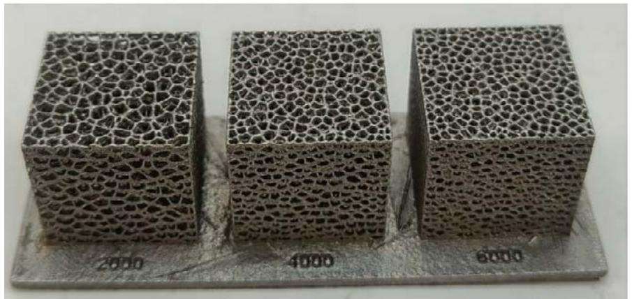
Figura 8 – Amostra 316L de geometrias Voronoi com 2000, 4000 e 6000 pontos, respetivamente.
