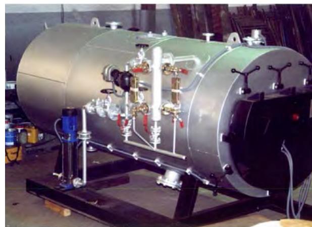
Foto do autor – Gerador de vapor fabricado pela Vaporel em fase final de aprontamento (final dos anos 90).
