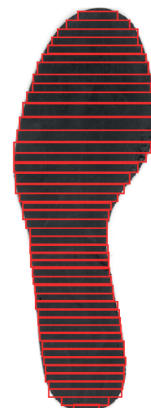
Figura 4 –Discretização da palmilha em segmentos para a deposição de cola
