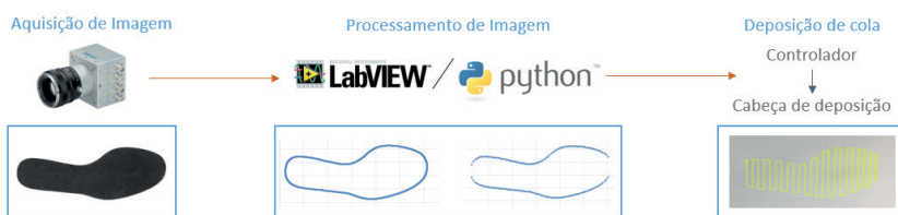
Figura 8 – Fluxograma de funcionamento do sistema de aquisição e tratamento de imagem
