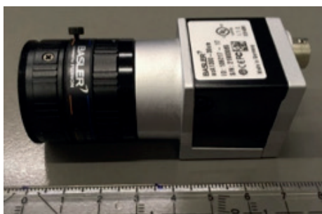
Figura 10 – Câmera industrial Basler acA-1300-30um, com lente C125-0818-5M-P f8mm.
